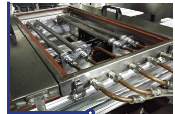
Tunel de N2 (Nitrógeno) en el área del Pot (olla)
